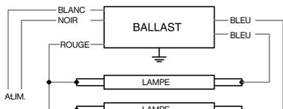
Pour les applications à trois lampes, apposer un capuchon de connexion sur le fil bleu isolé à 600V
