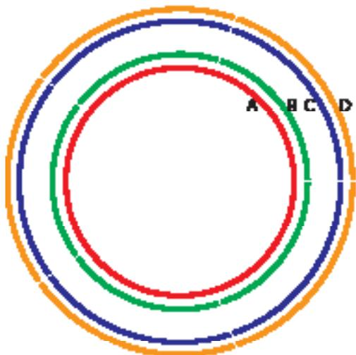
Une plaque pour tous les luminaires encastrés DEL de la gamme 4 po de Turolight. Anneaux de type débouchures enfonçables pour obtenir facilement l'ouverture recherchée.
