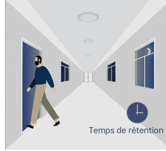
Le détecteur éteint automatiquement la lumière après le temps de rétention lorsqu'aucun mouvement n'est détecté.
