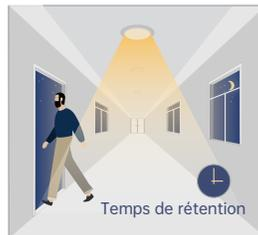
Si aucun mouvement n'est détecté, le détecteur maintient la lumière allumée à 100% pendant le temps de rétention.
